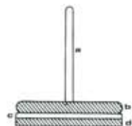
Fig. 5 - Elettroforo di Volta: A - Manico isolante. B - Piatto superiore, conduttore. C - Parte scoperta del piatto inferiore, isolante. D - Rivestimento conduttore di parte del piatto inferiore.
