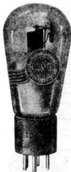
Valvola tipo 246 amplif. di potenza a doppia griglia.
