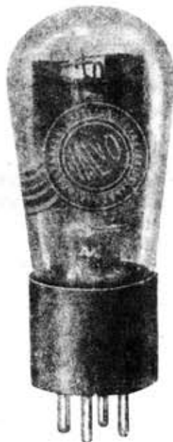
Valvola tipo 282 rettificatrice a vapore di mercurio.
