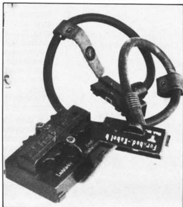
Fig. 2 - Questo è il componente per la regolazione fine di frequenza e del volume, corredato del suo cavetto di collegamento.
