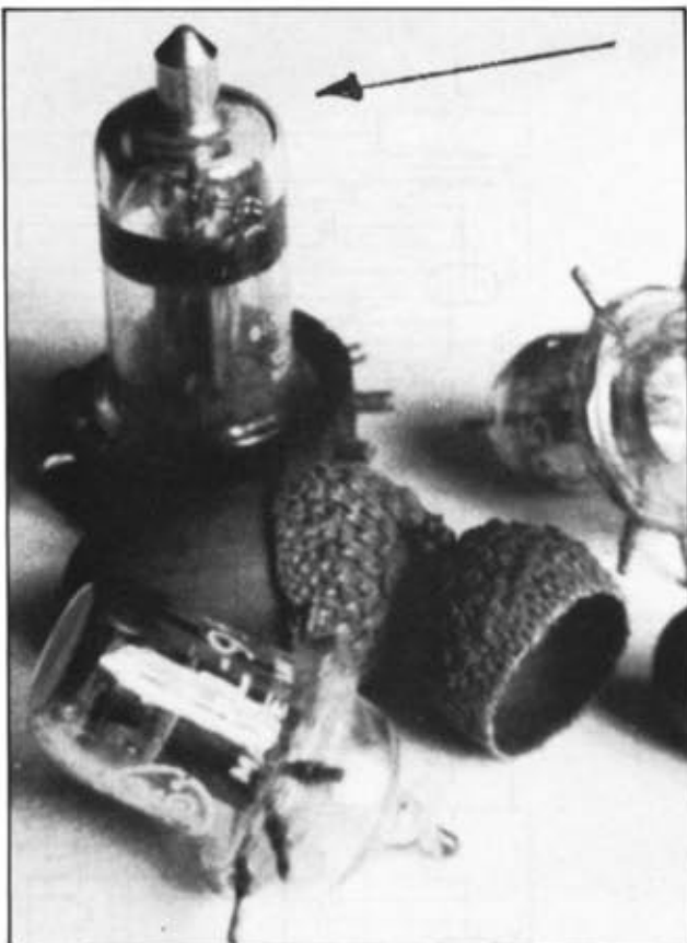
Fig. 8 - La freccia indica una delle valvole impiegate nel Feldfuspr. 1. Sono contemporanee di quelle americane dette valvole «ghian-da», in inglese ACORN. Le corrispondenti tedesche, pur essendo anch'esse un gioiello in fatto di miniaturizzazione e dalle stupende prestazioni tuttavia soltanto impropriamente molto spesso venivano chiamate valvole ghianda. Il tipo americano è in versione tutto vetro mentre la versione tedesca possiede uno zoccolo in bachelite, la qual cosa ne limita l'impiego alle altissime frequenze.
