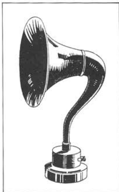
Il caratteristico altoparlante elettromagnetico con tromba a collo di cigno.
