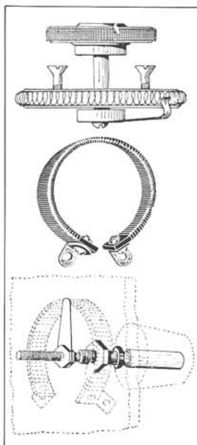
Il reostato per la regolazione dell'accensione dei tubi elettronici, costituito da filo di costantina avvolto a toroide.
