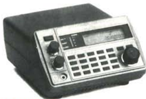
AOR AR-3000 Ricevitore-scanner a copertura continua nei modi di ricezione AM-FM-CW-USB-LSB. Campo di frequenza effettivo con continuità da 100 kHz a 2036 MHz. Alimentazione 13,8 V. Selettività e sensibilità eccezionali su tutte le bande.
