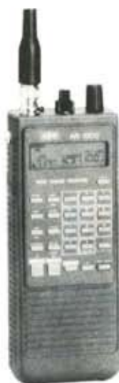
AOR AR-3000 Ricevitore-scanner a copertura continua nei modi di ricezione AM-FM-CW-USB-LSB. Campo di frequenza effettivo con continuità da 100 kHz a 2036 MHz. Alimentazione 13,8 V. Selettività e sensibilità eccezionali su tutte le bande.
