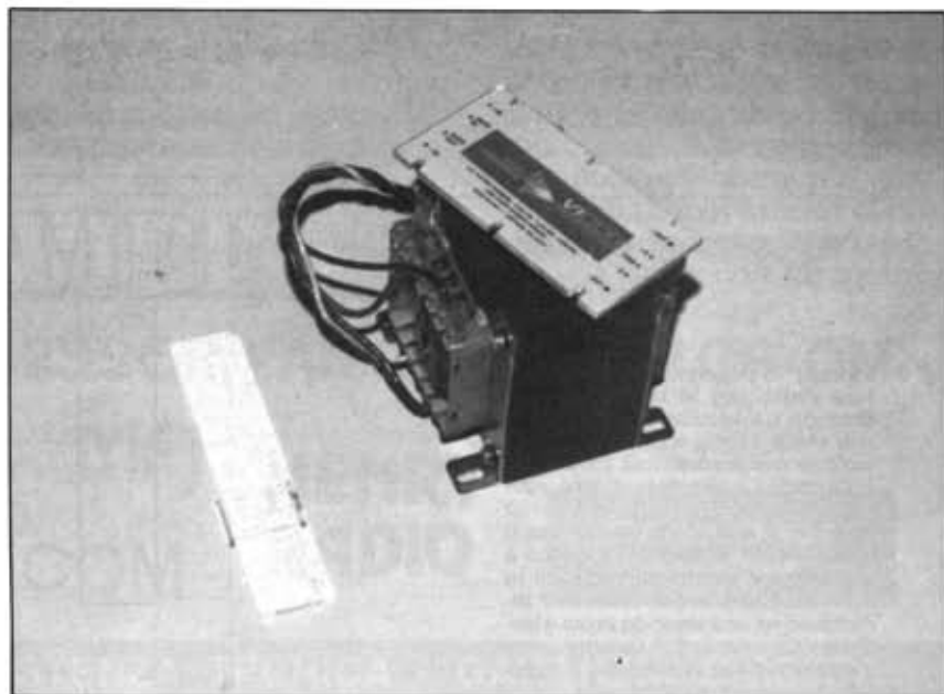
Fig. 7 - L'impressionante confronto tra un trasformatore tradizionale da 150 VA ed un modernissimo alimentatore a risonanza, con frequenza di lavoro di 1 MHz, in grado di erogare la stessa potenza (5V 30A).
