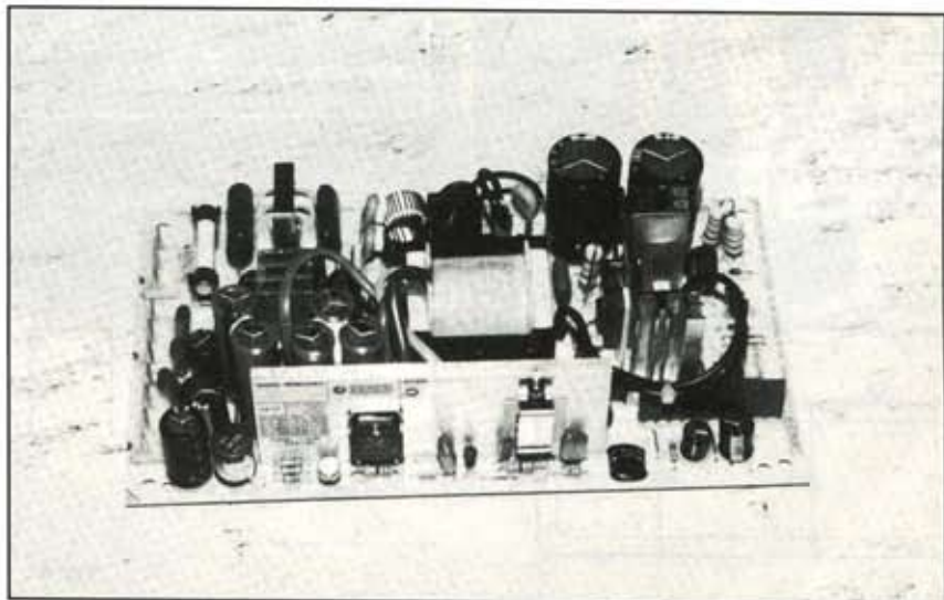
Foto 1 - Un convertitore di tipo buck, prodotto dalla SGS, in grado di erogare +5V 4A. Sono disponibili moduli della stessa famiglia con diverse tensioni d'uscita, sempre con 4A massimi. L'esemplare fotografato appare un po' malandato a causa delle severe prove cui è stato sottoposto in cella climatica, ma in realtà funziona ancora perfettamente.
