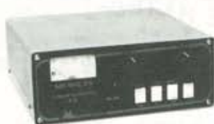
Amplificatore lineare 26-30 MHz; 500 W PeP AM-FM-SSB
