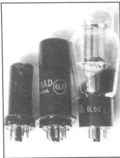
Fig. 2 - A confronto sempre la 6L6 con la versione metallica e accanto la 6V6 metallica.
