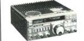
YAESU FT 757 GX II Ricevitore HF, FM, AM, SSB, CW, trasmissione a ricezione continua da 1.5 a 30 MHz, ricezione 0.1-30 MHz, potenza RF-100 W PeP in SSB, CW, scheda FM optional.
