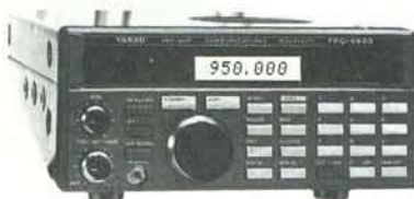
FRG-9600 Ricevitore all mode NUOVA ESTENSIONE 60 ~ 950 MHz
