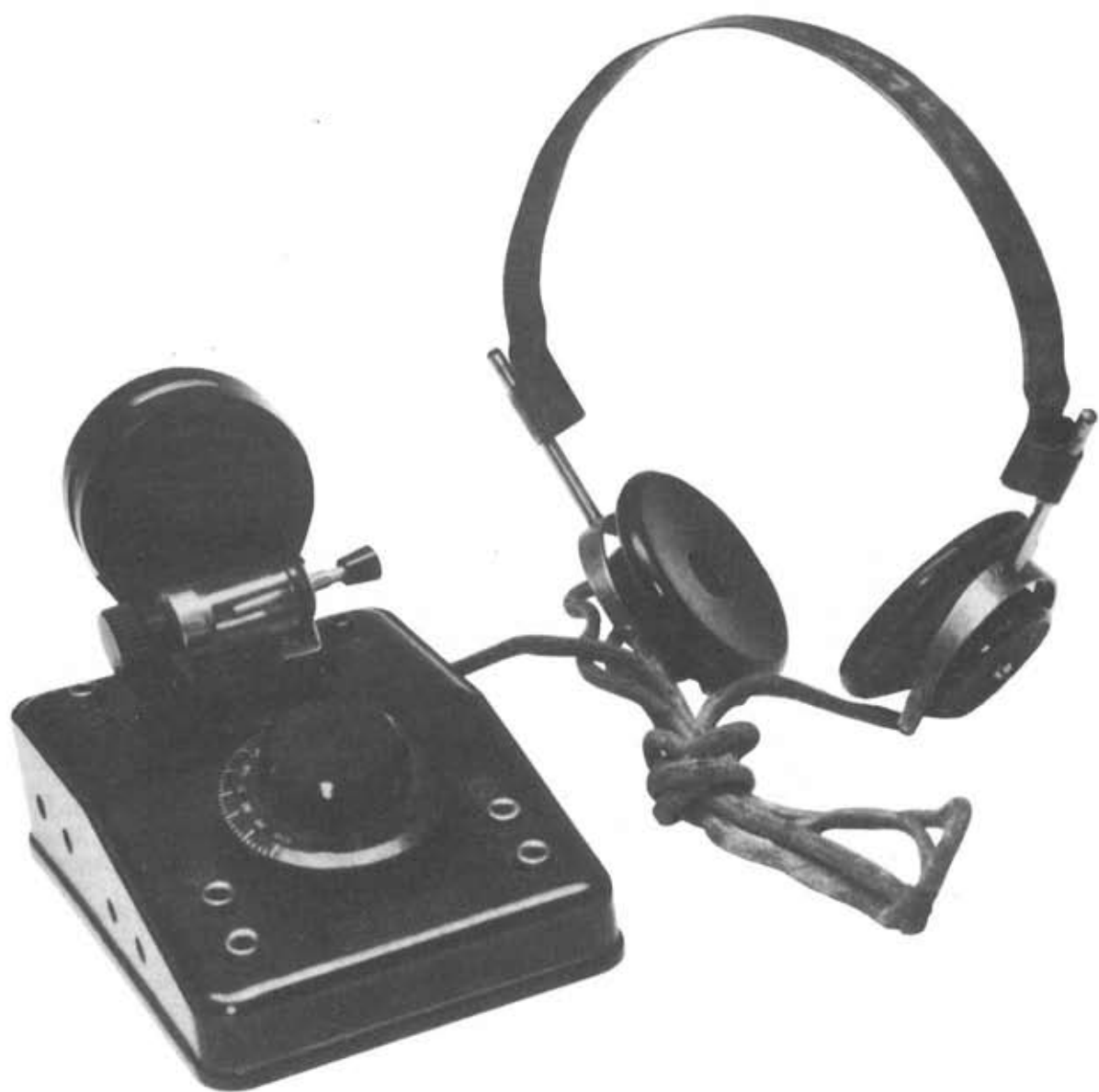
Radioricevitore a galena: mobiletto e accessori VAAM anni 40; detector a tubetto; bobina a nido d'api. Corredata di cuffia SAFAR EJA 500 (del 1932)
