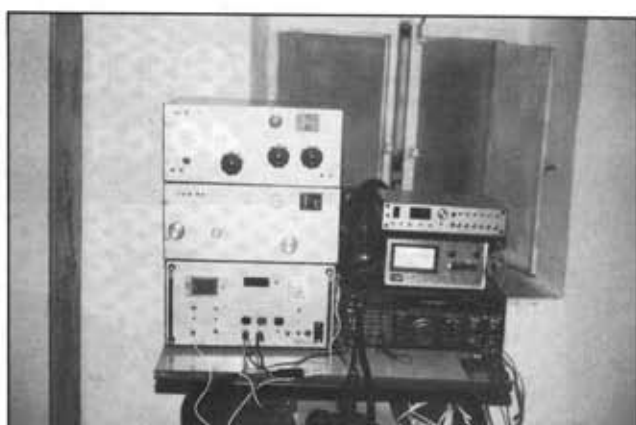
Stazione I2CVC/7 - FT790 Rotatore bug elettronico 6 memorie alimentatore P.A. 144 PA 432
