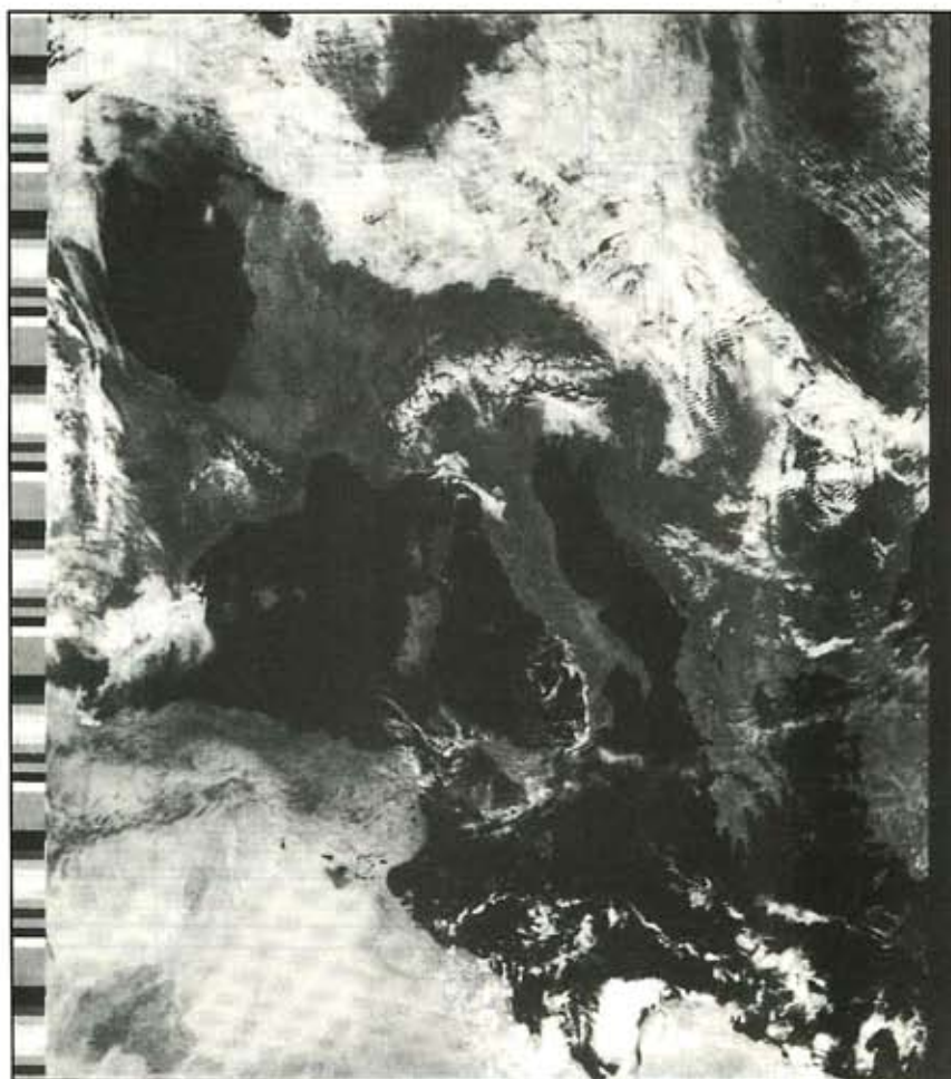
Fig. 1 - NOAA-11, APT, canale VIS, 7 marzo 1990, 1235-1250 UTC, ascendente. L'immagine è stata elaborata per aumentare il contrasto terra-mare. Di conseguenza nella colonna dei dati telemetrici le tonalità di grigio non sono rispettate e sono scomparsi i marker bianchi nella scansione dello spazio.
