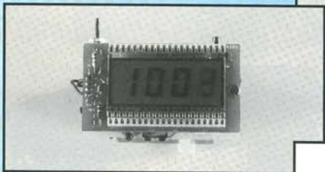
MK 1735 BAROMETRO ELETTRONICO CON DISPLAY A CRISTALLI LIQUIDI 3 CIFRE E 1/2
