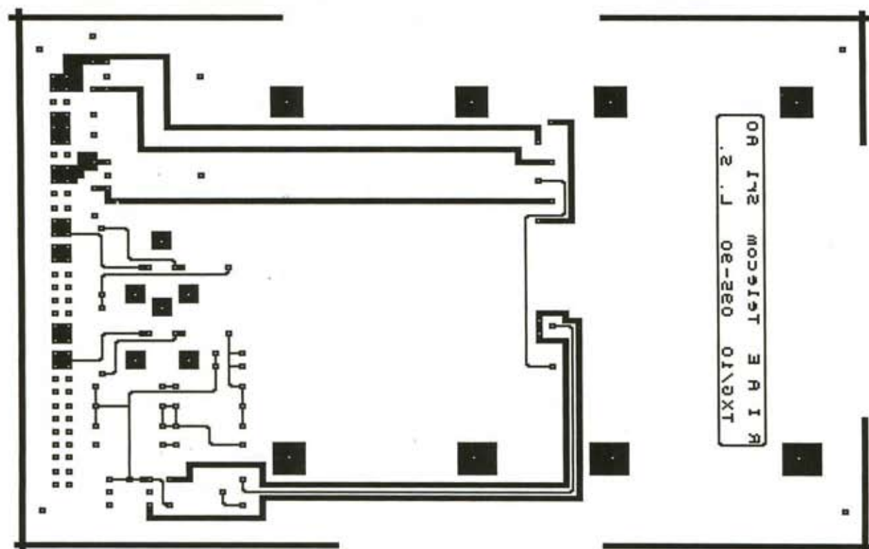
Stampato supporto eccitatore. Lato saldature
