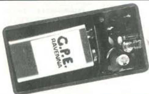
MK 1620 RX RICEVITORE PER TELECOMANDO A RAGGI INFRAROSSI
