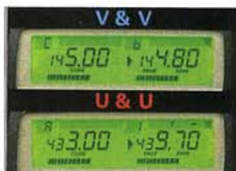
Esempio di ricezione simultanea di due frequenze nella stessa banda
