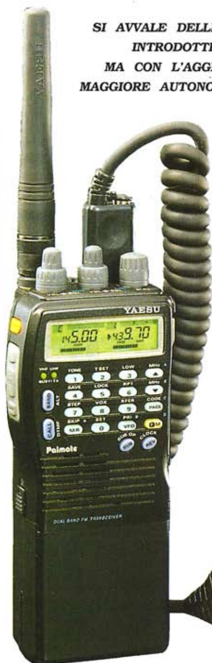
Esempio di ricezione simultanea di due frequenze nella stessa banda
