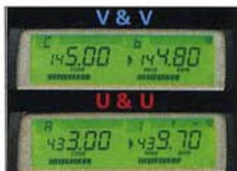
Esempio di ricezione simultanea di due frequenze nella stessa banda
