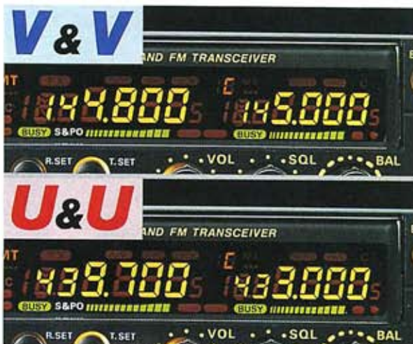
Esempio di ricezione simultanea di due frequenze nella stessa banda
