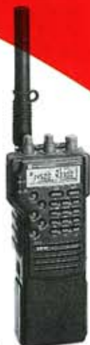
C-520 RICETRASMETTITORE BIBANDA VHF/UHF FULL DUPLEX
