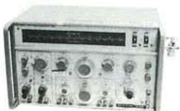
Generatore MARCONI TF 2008. AM - FM - SWEEP. Da 10 kHz a 510 MHz. Livelli RF e modulazione automatici. Presa per counter. Calibratore interno. Stato solido. Cassetta accessori. L. 1.680.000 ivato
