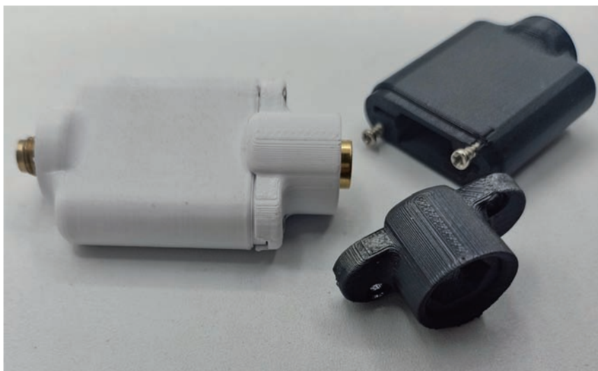
Fig. 4 - Il box stampato in PLA con una stampante FDM
