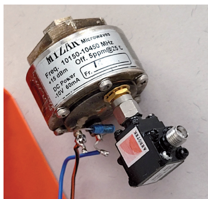
Fig. 4 - Oscillatore DRO e circolatore utilizzati nel Test Transmitter
