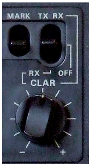
Fig. 2 - Dettaglio del clarifier dello Yaesu FT-221R. In basso la manopola del clarifier. In alto a destra il commutatore del clarifier: solo RX, escluso, sia RX che TX. Il comando MARK non c'entra.
