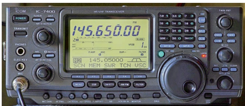
Fig. 3 - L'Icom IC-7400 è un apparato di una ventina d'anni fa, ma tuttora valido. In Fig. 4 si vede il dettaglio della parte che interessa questo articolo. Il pulsante verde, in alto a sinistra rispetto alla manopola di sintonia, è l'XFC, descritto più avanti
