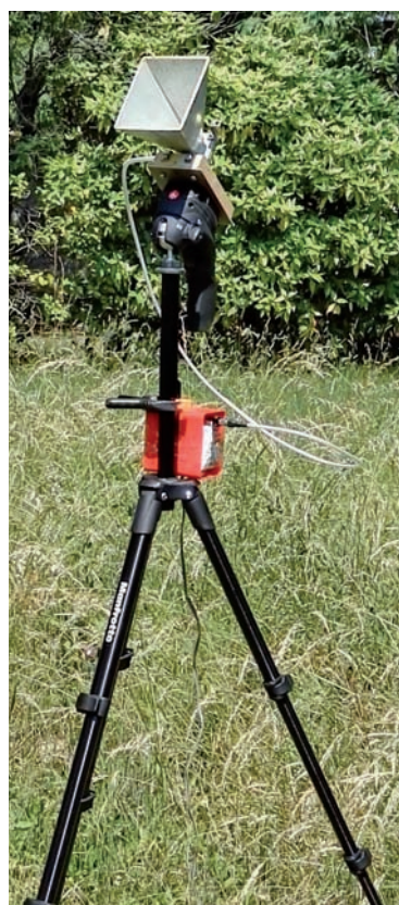
Fig. 2 - Esempio di posizionamento antenna trasmittente
