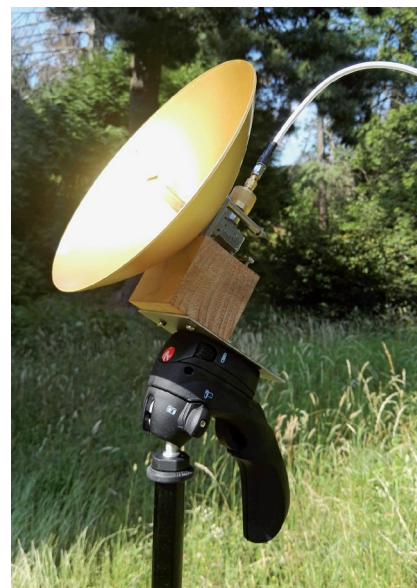
Fig. 11 - Parabola da 20 cm montata e collegata al Test Transmitter.
