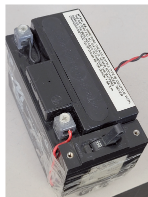
Fig. 6 - Batteria di alimentazione del Test Transmitter
