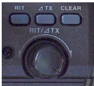
Fig. 4 - Dettaglio dell'IC-7400 relativo alla parte RIT e ΔTX. In basso la manopola dell'encoder. In alto da sinistra a destra, i tre pulsanti per inserire il RIT, inserire il ΔTX, azzerare entrambi.
