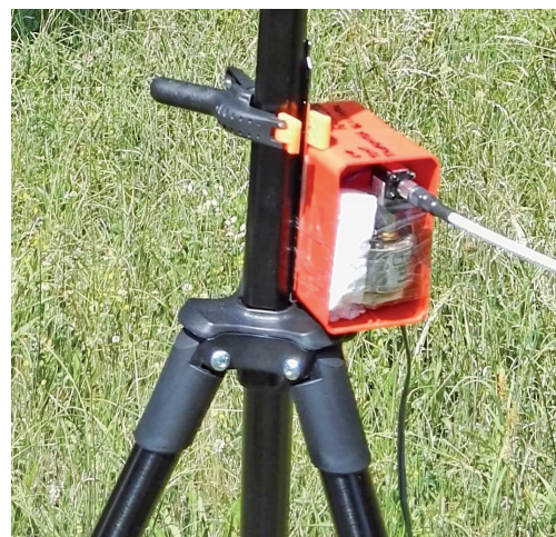
Fig. 8 - Particolare del fissaggio semifisso del Test Transmitter al treppiede
