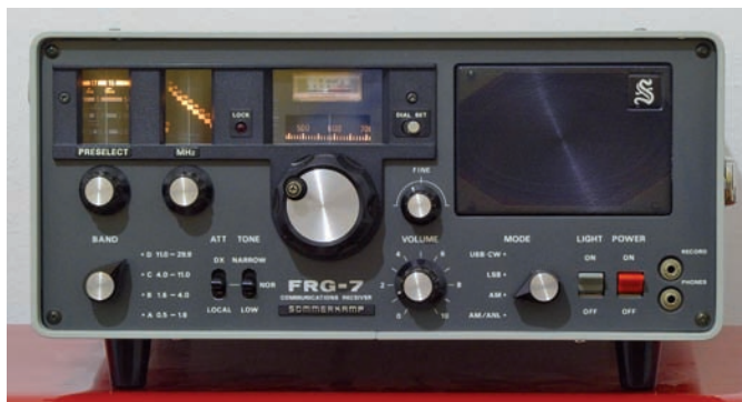
Figura 1 - Il Sommerkamp (Yaesu) FRG-7, terzo ricevitore acquistato dall'autore. La mediocre qualità audio faceva rimpiangere il Drake SSR-1
