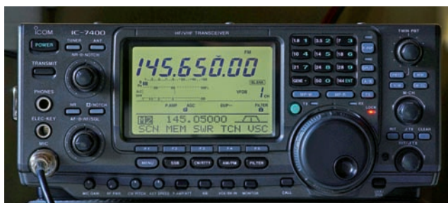
Figura 3 - L'Icom IC-7400 dell'autore. L'immagine dovuta alla seconda IF (910 kHz sopra la frequenza ascoltata) è più forte di quella della prima IF. Tuttavia l'attenuazione di 75 dB basta per non creare problemi, salvo in casi eccezionali.
