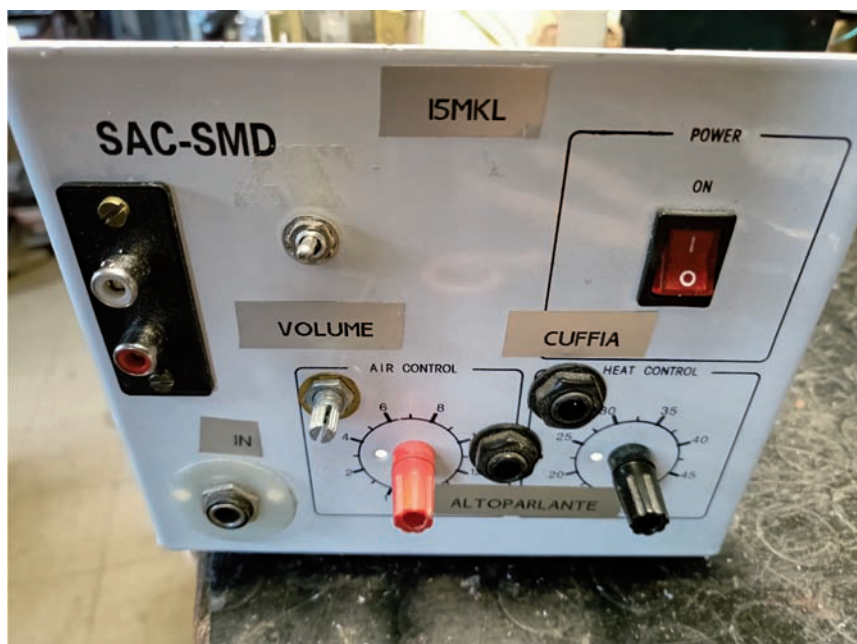
Figura 4 - Foto del pannello anteriore. L'ingresso può essere utilizzato sia come jack da chitarra che come R.C.A. L'uscita altoparlante è possibile sia con banane che con jack da chitarra. La presa cuffia è uno standard jack da chitarra
