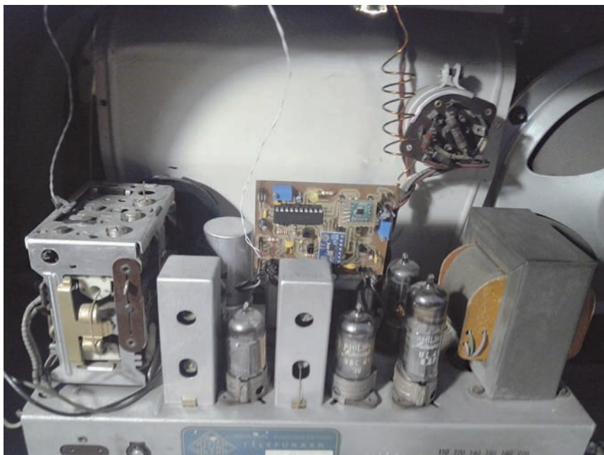
Foto 3 - Uno dei primi prototipi: installazione in una Telefunken T33B. Il convertitore è appoggiato sopra il trasformatore d'uscita e mantenuto in posizione dal magnete. Il pezzo di filo smaltato avvolto a spirale è l'antenna FM mentre i fili bianchi fanno parte del link captatore che ho infilato nel gruppo di sintonia.
