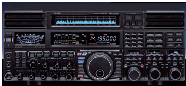
Figura 2 - Lo Yaesu FTDX5000, apparato di punta della casa giapponese, ora sostituito dall'FTDX101. Si tratta di un down conversion con la prima IF a 9 MHz
