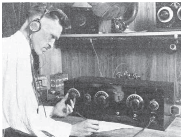
Fig. 6 - Questa foto dimostra in modo inequivocabile le difficoltà di sintonia del ricevitore TRF. Le tre manopole più grandi sono la sintonia. La prova? Guardate la faccia ingrugnata del signore che la usa: dice tutto
