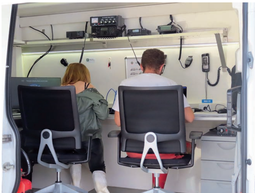
Fig. 10 - Alluvione in Emilia-Romagna. La giornalista RAI e il relativo operatore utilizzano la connettività LTE/4G long-range fornita dal nostro PCA per inviare il servizio che a breve sarebbe andato in onda al telegiornale. Sullo scaffale fa bella mostra di sé l'apparato HF Icom IC-7200 che è l'ultima carta da giocare in casi estremi
