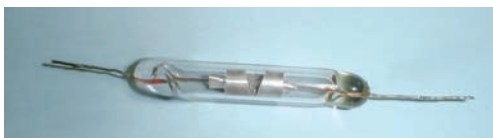
Fig. 1 - Un coherer di buona fattura
