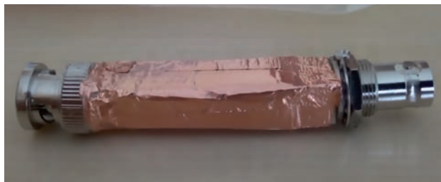
Nastro di rame schermante applicato
