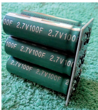
Fig. 4 - Gruppo di sei supercondensatori in serie da 100F e 2,7V l'uno per un totale di 16,7F e 16,2V
