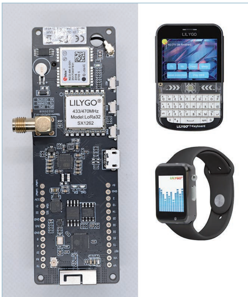
Fig. 3 - Altri dispositivi programmabili con ESP32 presenti sul mercato. Qui vediamo solo alcuni esempi, come una scheda che integra LoRa e GPS, un apparato con tastiera e display e perfino un orologio.
