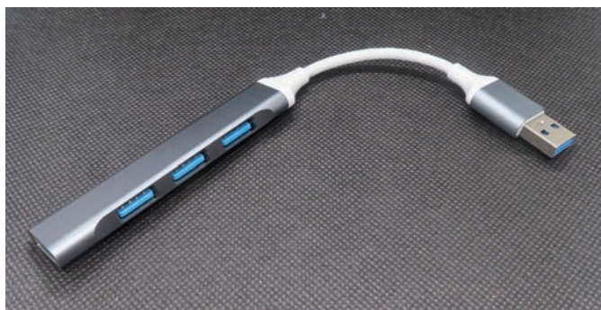
Fig. 7 - Hub USB acquistato a 3.50€ su sito cinese. Necessario per collegare più di un dispositivo alla singola porta USB disponibile sui PI Zero. Purtroppo si trovano solo con spina USB-A (come in foto) o USB-C e non micro USB, come servirebbe per i PI Zero
