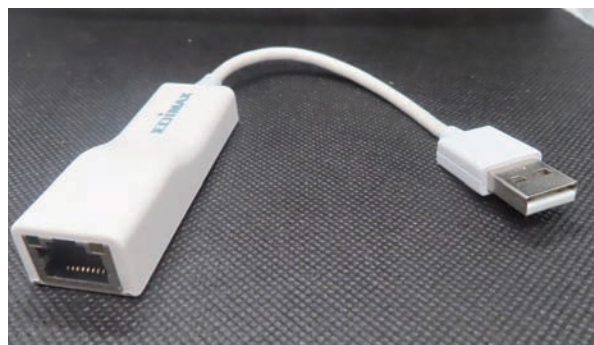
Fig. 8 - Unità ethernet con connessione USB. Collegata al Raspberry, viene immediatamente identificata e collegata alla rete
