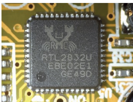
Fig. 1 - Immagine ravvicinata del circuito integrato Realtek RTL2832U, il cuore di tutto il processo di campionamento
