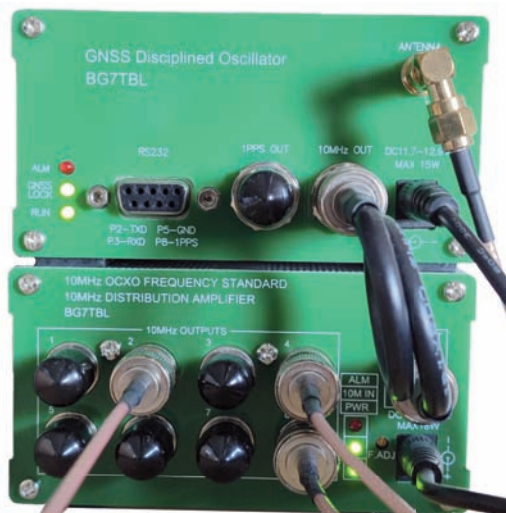
Foto 1 - GNSSDO e SPLITTER
