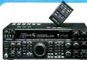
TS 950 SDX Tutte le bande amatoriali da 160 a 10 m. Processore di segnale digitale, finali a Mosfet.
