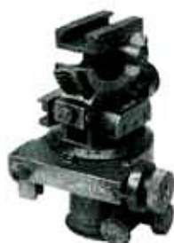
Goniometro S. Giorgio per dare i dati di tiro ai mortai. Anno di costruzione 1918. Mancante del cannocchiale di puntamento. Interamente in ottone. Bellissimo oggetto. L. 35.000
