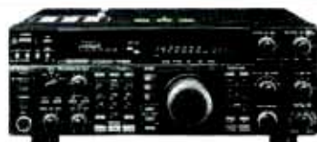
TS 850 S-AT - Ricetrasmittitore HF - Potenza 100W - Accordato- re d'antenna incorporato
