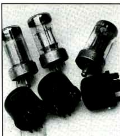
Fig. 5 - La figura illustra i due tipi di valvole impiegati rispettivamente sul modello WR1/P e WR1/T.
