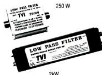
FILTRI PASSA BASSO PER HF 1,6-30 MHz
