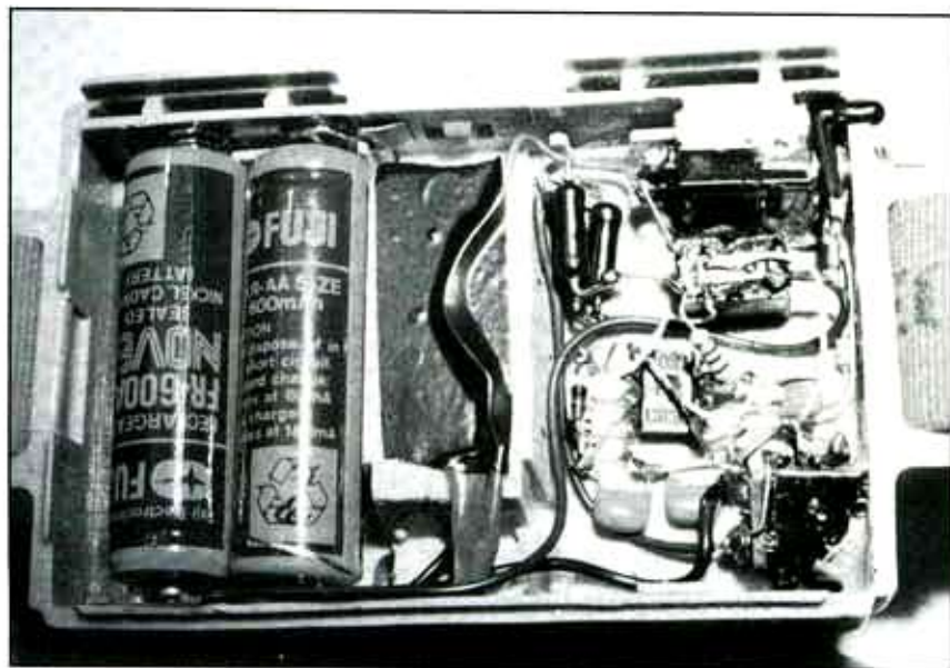
Fig. 1 - L'interno della lampada. Il relè e l'integrato sono incollati rovesciati alla scatola.
