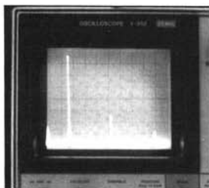
Foto 5 - Analisi di spettro dopo accordo AT, freq. 3750, in altezza il quadretto = 10 dB: si vedono 2ª, 3ª e altre armoniche, ben attenuate.
