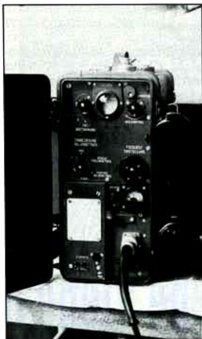
Ricetrasmittitore R108D con pannello in lingua tedesca. Da notare la mancanza del comando del volume e dello squelch.
