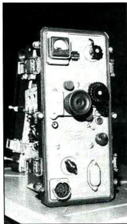
Ricetrasmittitore VHF R105M. La frequenza di lavoro è visibile nell'oculare posto al centro del pannello.
