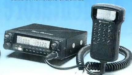
UNITA' RADIO CON MICROFONO TERMINALE DI SERIE E FRONTALINO OPZIONALE
