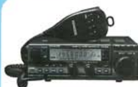
TS 50S HF veicolare per SSB - CW - FSK - FM, 100 memorie, doppio VFO, potenza 100 W
