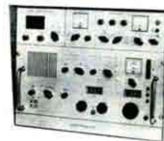
Ricevitori EKV tipo 1340.36 della R.F.T. VEB Funkwerk Köpenick da 1600 Kc a 30 Mc. Tripla conversione. Lettura digitale meccanica, risoluzione 100 Hz. Ri- velatore a prodotto per SSB - Filtri meccanici - AGC 0,2 e 2 secondi o manuale. Interamente a stato solido. L. 650.000
