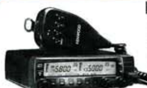
TM 733 E Ricetrasmittitore veicolare bibanda FM 144-430 MHz con frontaltino estraibile
