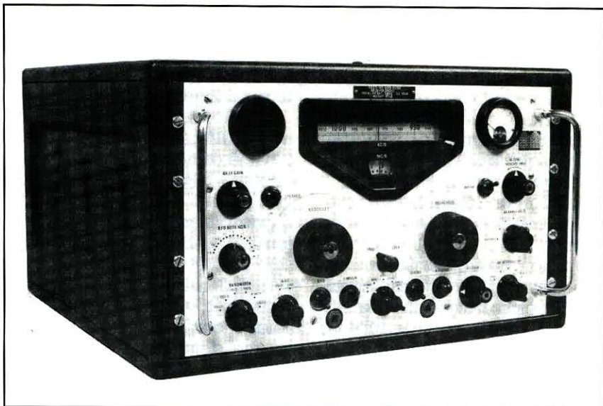
Fig. 1a - RACAL RA 17 capostipite dei ricevitori professionali moderni a banda continua
