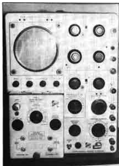
Il Tektronix 585A con il relativo adattatore Type 81 che consente l'impiego dei cassette della serie alfabetica, in questo caso il Type L, che ho poi modificato per ricavarci un tracciato per transistor.
