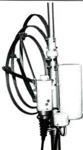
Antenna professionale modello 79; con sintonia continua da 16 MHz fino a 2,9 MHz (divisa in tre settori, rispettivamente da 16 MHz fino a 6,25 MHz; da 6,3 MHz fino a 4,15 MHz; da 4,2 MHz fino a 2,9 MHz). Naturalmente, quest'antenna può lavorare sia in trasmissione, come pure in ricezione, su qualsiasi punto dell'arco di frequenze qui sopra indicato. Il ROS max è di 1,2 + 1,4 (nelle condizioni atmosferiche più difficili). Quest'antenna tiene una potenza fino ad 1 kW, senza perdite di rendimento, e (su richiesta) può essere costruita anche per potenze di 2 kW. Siamo disponibili a dare campioni in visione/prova gratuita senza alcun impegno d'acquisto od altro, agli Uffici o Enti dello Stato e della Pubblica Amministrazione. Esaminiamo, comunque, qualsiasi altra richiesta (nei limiti della nostra disponibilità di materiale pronto) purché la richiesta stessa (di visione/prova gratuita) sia redatta su carta intestata, completa dell'eventuale numero d'iscrizione alla Camera di Commercio (od altro), ed anche della Partita I.V.A. e del Codice fiscale, ecc.
