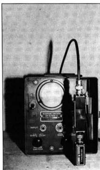
Lo strumentino usato definitivamente per questo specifico scopo, è quello contenuto nel MICROPHONE SIMULATOR SM-30/URM-14 (vedi foto a lato).
