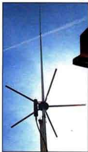
Antenna "ALL" verticale a copertura continua da 1,8 a 30 MHz
