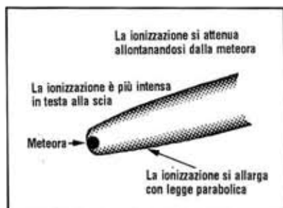
Fig. 5 - La ionizzazione della coda di una meteora viene usata come riflettore delle onde radio.
