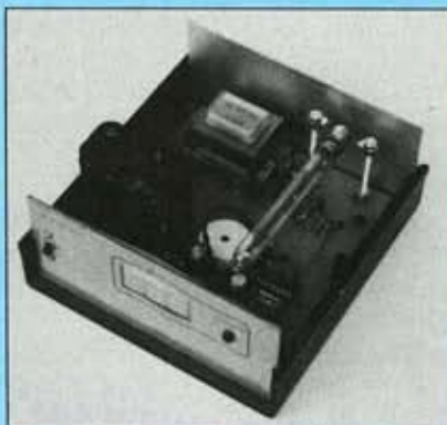
MK 2615 Contatore Geiger con µProcessore
