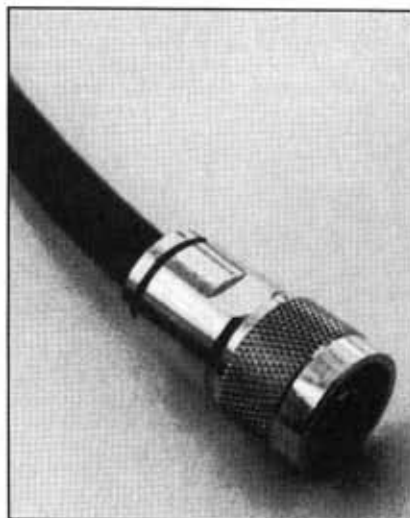
Fig. 3 - Il lavoro ultimato, cioè il connettore completamente installato; si può notare che fra dado posteriore e corpo rimane una distanza molto modesta, e questo è perfettamente normale.
