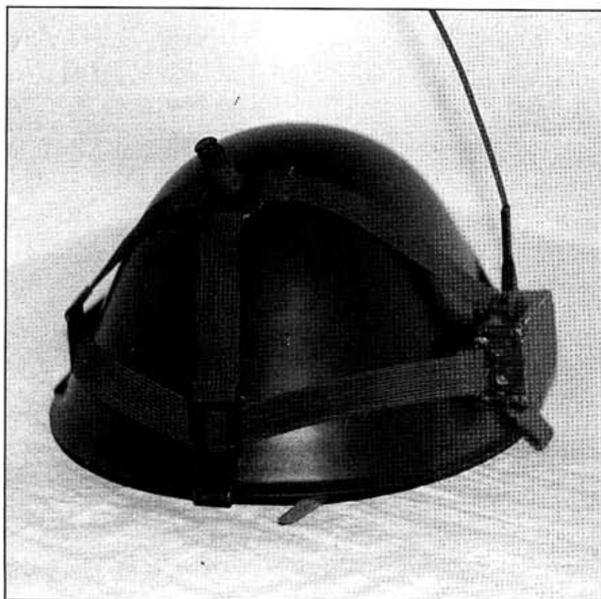
Fig. 4 - L'antenna montata sopra l'elmetto.
