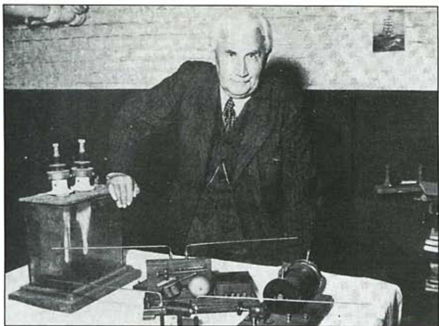
Christian Hülsmeyer con il suo Telemobiloscopio come tuttora visibile nel museo di Dusseldorf. È considerato il primo radar realizzato al mondo nel lontano 1904.
