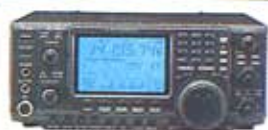
ICOM IC 746 Ricetrasmittente all mode SSB/ CW/AM/FM/FSK in tutte le bande HF +50 MHz +144 MHz Potenza 100W su tutte le bande
