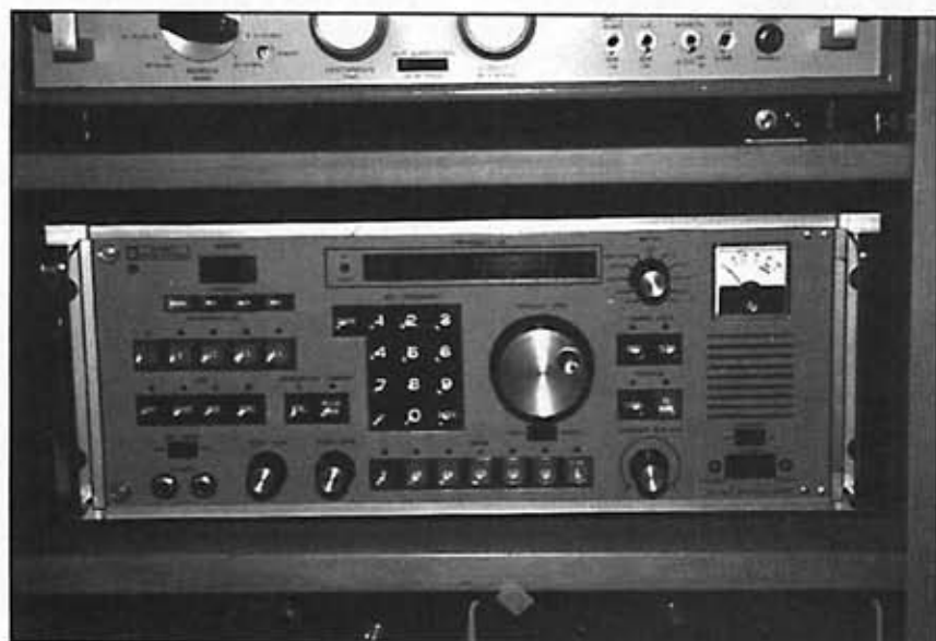
Foto B - Il ricevitore PLESSEY PR 2250 in funzione al termine delle modifiche. Si noti l'accensione del LED relativo al modo "USB" (in basso al centro) e pure del LED corrispondente al "filtro aggiuntivo" (in alto a sinistra).
