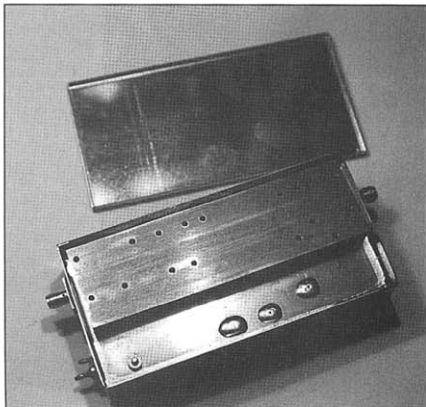
Fig. 7 - Veduta dell'amplificatore dal lato massa, senza dissipatore: questo è fissato alla barra di rame a mezzo di viti
