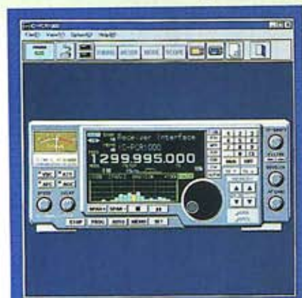
schermo ricevitore: visualizza lo strumento S-Meter, il display per la frequenza, la tastiera e tutti gli altri controlli, per una completa visione del ricevitore
