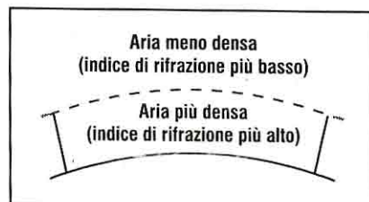
Fig. 2 - I radiosegnali viaggiano sin oltre l'orizzonte poiché si pieghino verso la zona di più elevato indice di rifrazione.
