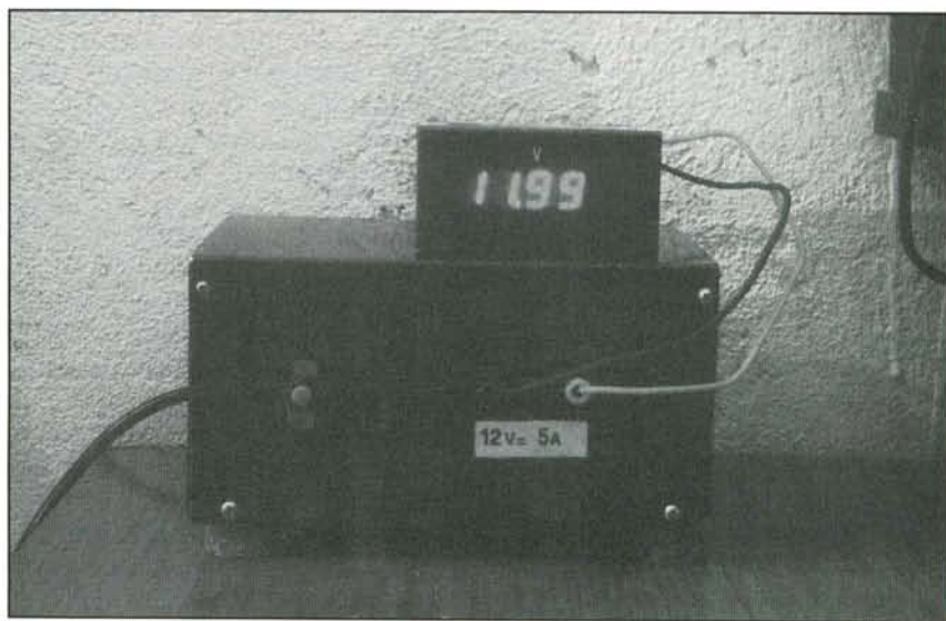
Vista anteriore alimentatore 5 A. Sotto prova con strumento digitale.
