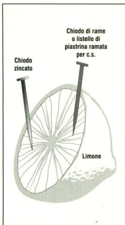
Fig. 3 - Per realizzare un tipo rudimentale di pila basta un frutto acido (specie se un agrume), un listello di bassetta ramata per circuiti stampati ed un chiodo zincato.
