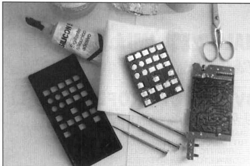
Gli utensili ed i materiali usati in questo progetto (mancano le pinzette)
