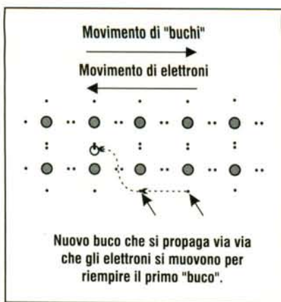
Fig. 3 - Movimento di «buchi» (a carica positiva)
