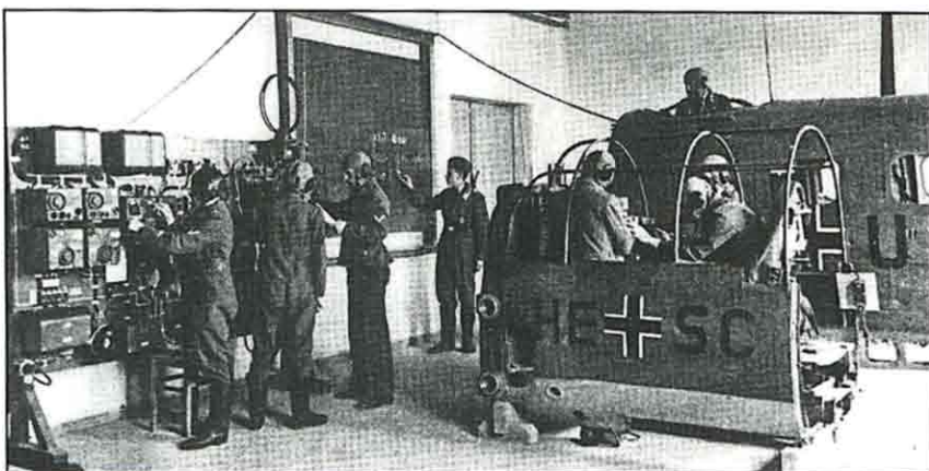
Fig. 5 e 6 - Due momenti che illustrano il sistema di addestramento del personale circa l'uso del FuG10 in ambiente che simulava la sistemazione reale in un certo velivolo.
