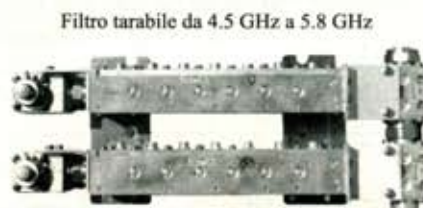
Filtro tarabile da 4.5 GHz a 5.8 GHz
