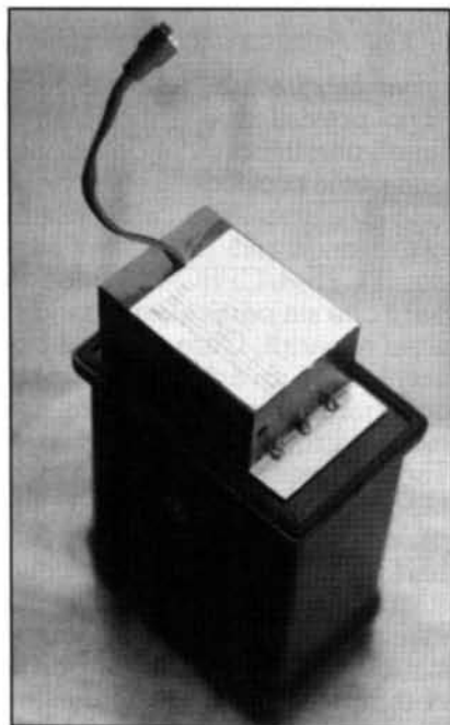
Alimentatore da 6 Vcc inserito al posto della pila originale
