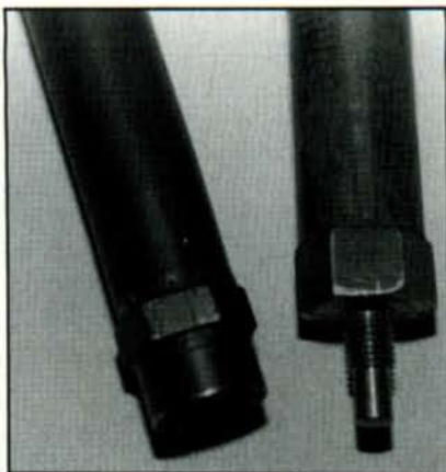
Supporti per antenna lunga. A destra il modello AB-591. A sinistra la versione modificata per la SEM 35
