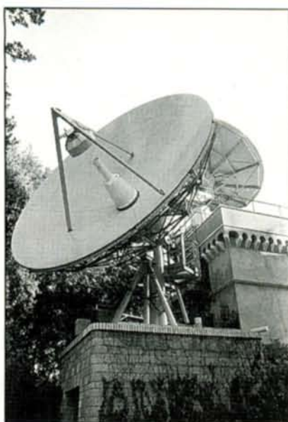
Fig. 7 - I riflettori parabolici delle due stazioni terrene per trasmissioni via satellite
