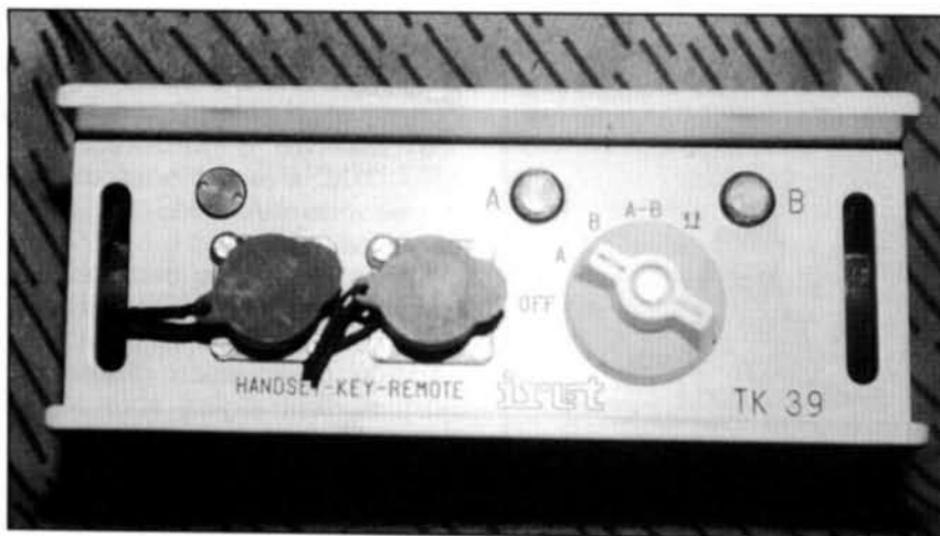
Foto 5 - L'unità di traslazione TK 39
