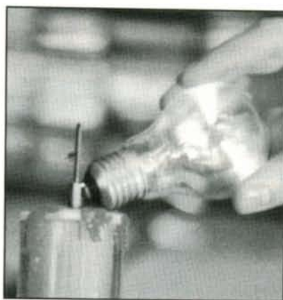
Fig. 24 e 25 - L'esperimento "classico" del trasformatore di Tesla è l'accensione di un tubo al neon avvicinato a qualche centimetro dal trasformatore stesso; utilizzando una lampada a filamento, anche bruciata, si ottiene invece il particolare effetto illustrato a destra.
