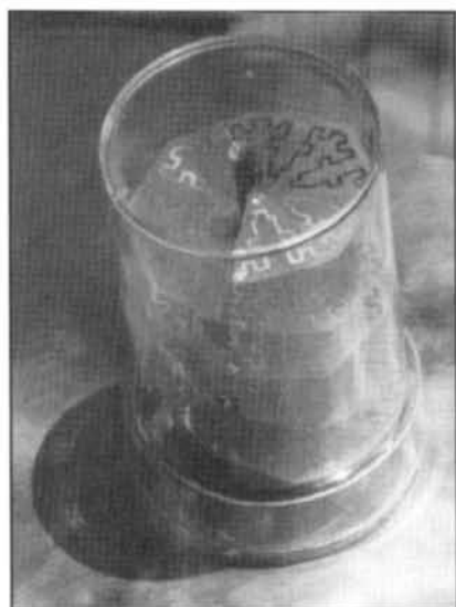
Foto 1 - Antenna frattale ad elica per i 675 MHz di 7,4 cm di diametro e 12 di altezza (circa 1/3 di un'elica convenzionale) con guadagno di 7dB.
