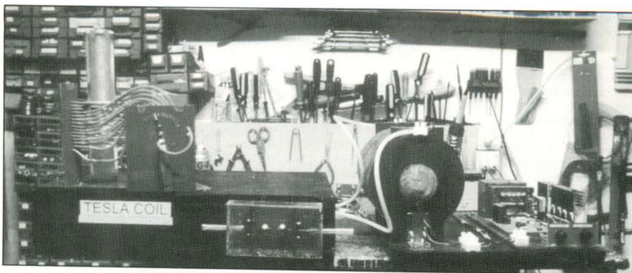
Vista generale del trasformatore RF collegato al rocchetto
