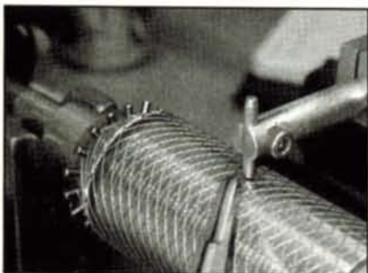
Fig. 1 - Fabbricazione di un filamento "mesh"
