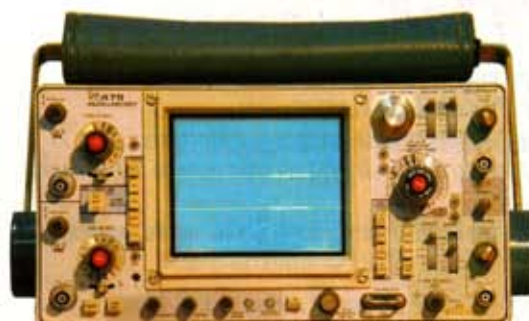
Tektronix 475 - Oscilloscopio 200 MHz, 2 canali, sensibilità da 2mV a 5V/div, doppia base tempi. Condizioni eccellenti. £ 1.500.000 Disponibili anche Tek 465 (100 MHz) a £ 1.100.000 e Tek 475A (250 MHz) a £ 1.800.000
