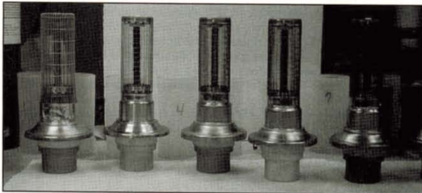
Fig. 2 - Griglie di 3CX3000A7 durante la lavorazione
